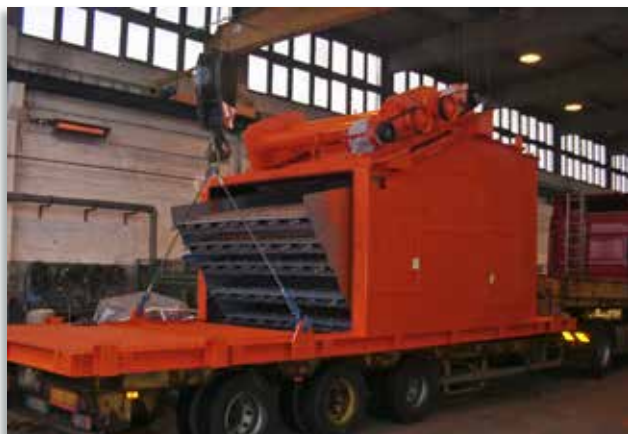
Schneller Zugang zu den Siebdecks
