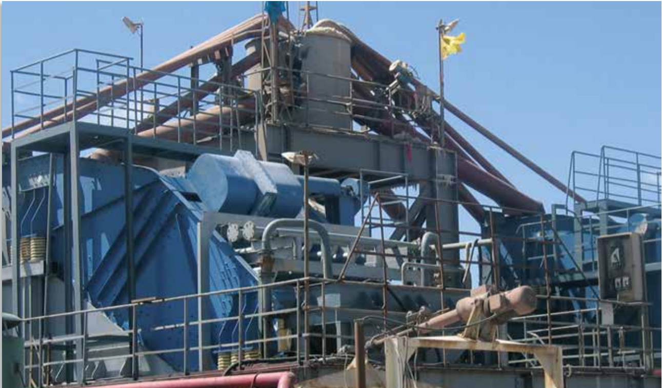
Getriebesieb Typ BHG, Bananensiebmaschinen in der Absiebung von Kalisalz in China
