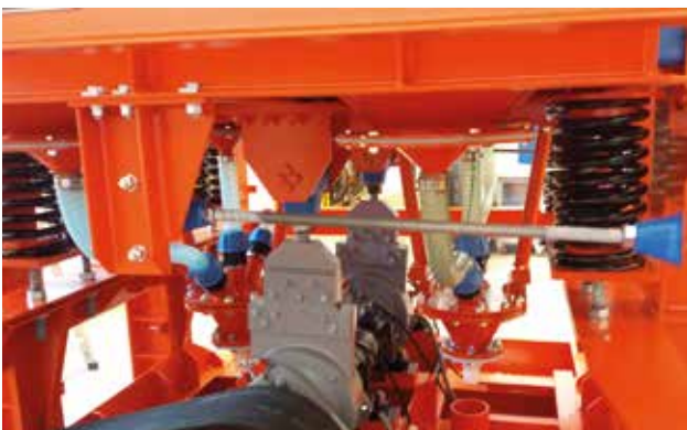
Mechanischer Exzenterantrieb leistet die Hubarbeit
