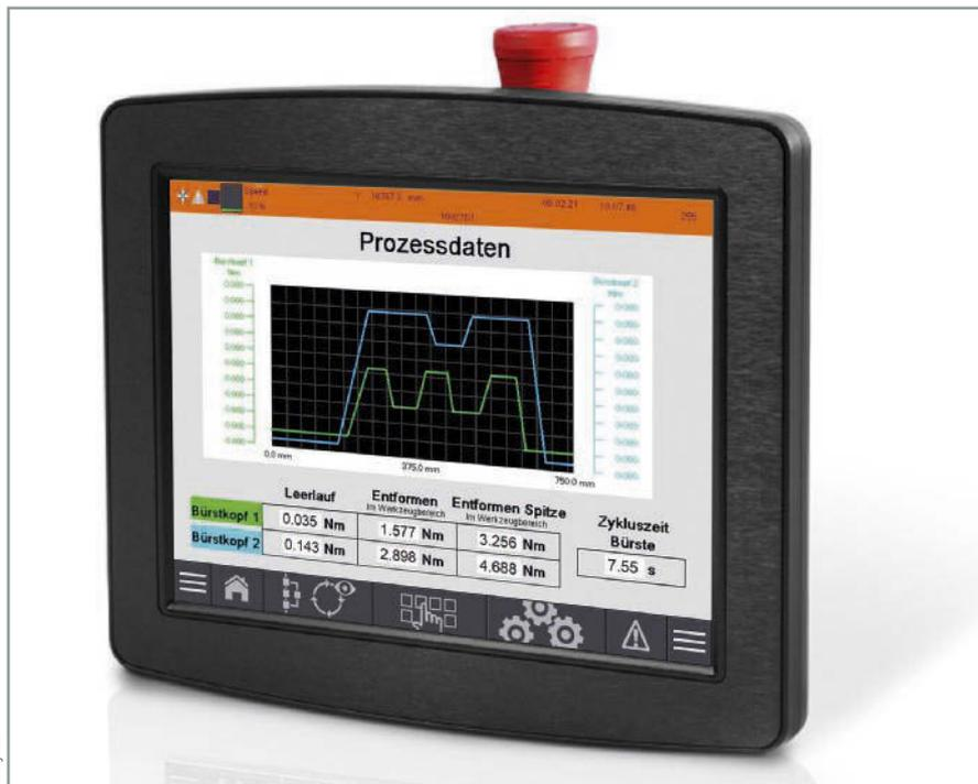
Über die Visualisierung lassen sich sämtliche relevanten Parameter der Bürstwerkzeuge einstellen, optimieren und im laufenden Prozess überwachen.
