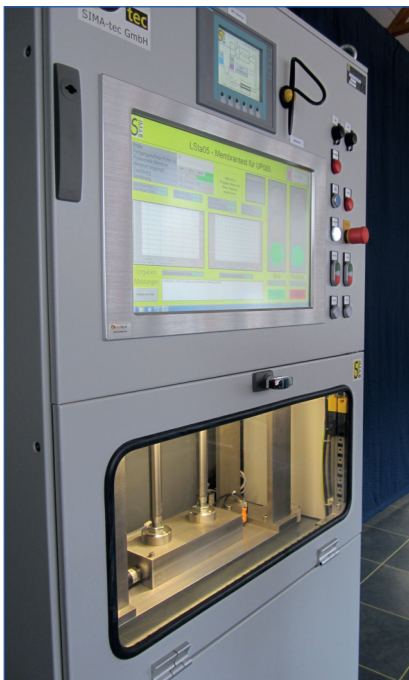
Abb. 2: Außenansicht der Testanlage mit geschlossener Testzelle und geschlossener Fronttür
