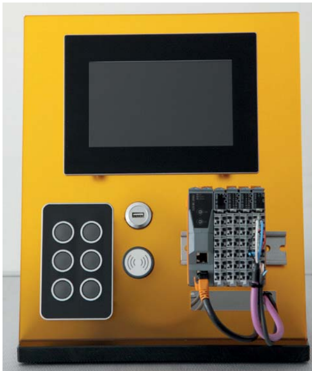
Die wesentlichen Bestandteile der „Orange Box“: Mapp Technology und Scalability+ von B&R
