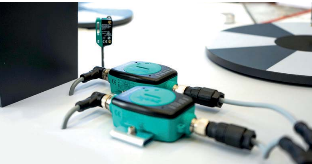
Die „SmartBridge“-Technologie von Pepperl+Fuchs unterstützt mit dem IoT-Connector sowohl die Anbindungen an die gängigen Sensorschnittstellen als auch an verschiedene Cloud-Systeme
