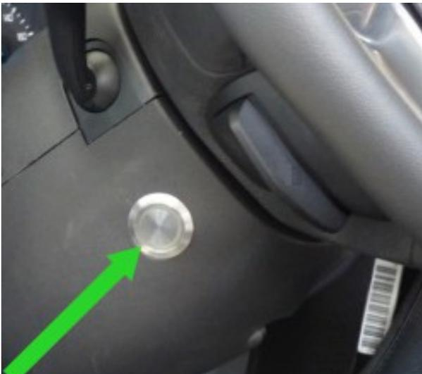
Verbau des Tasters erfolgt z.B. an der Verkleidung des Lenkstocks
