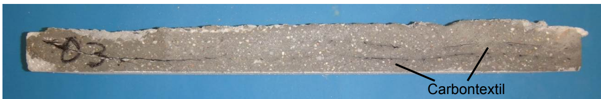
Bild 9: Verlauf der Textilien beim Laminierspritzverfahren
