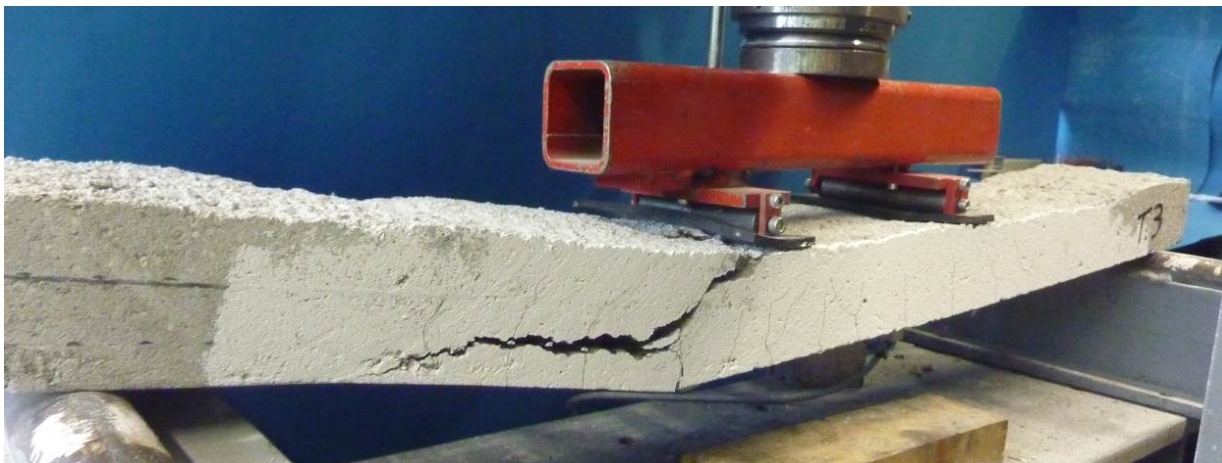
Bild 13: Bruchzustand des Biegekörpers mit dem Textil 2 (Tab. 1)
