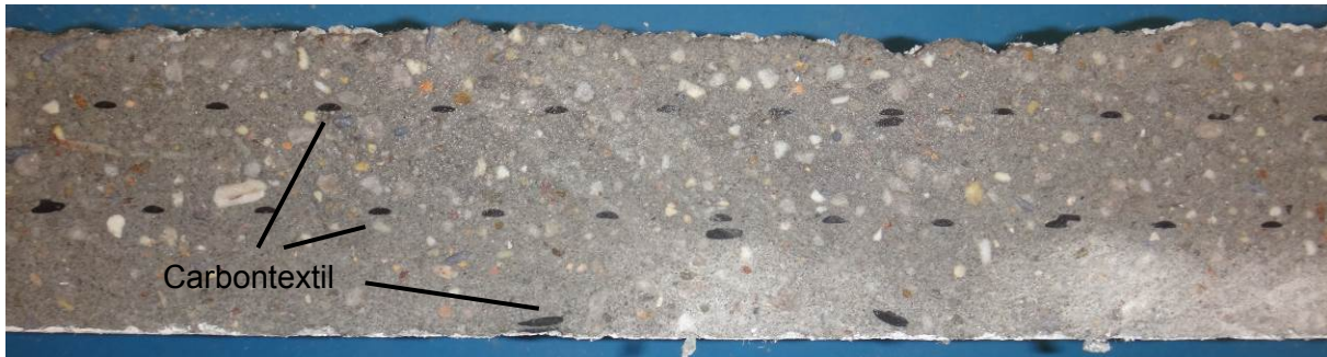
Bild 10: Detail vom Prüfkörper nach dem Verfahren 2 mit vollständiger Ummantelung und großer Lagegenauigkeit des Carbontextils
