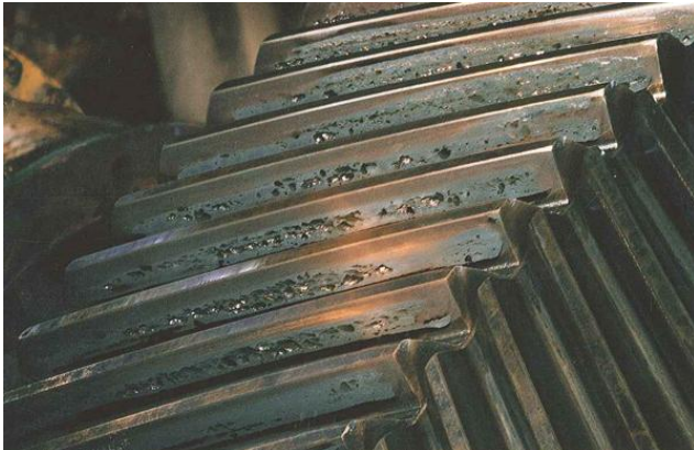
Abbildung 3: Kleine Grübchen, zurückzuführen auf Überlastung, werden als Pitting bezeichnet. 20
