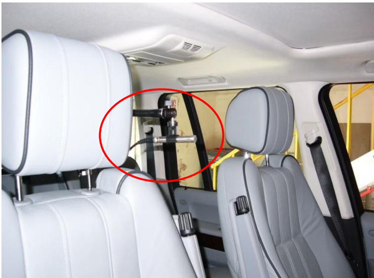
Abbildung 39: Die Messposition für Luftschall war am Fahrerohr links.
