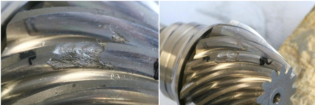
Abbildung 31: Grobflächiges Pitting am Triebfling
