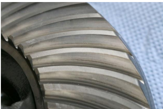
Abbildung 32: Das Tellerrad des Kegelradgetriebes weist keine Schäden auf.
