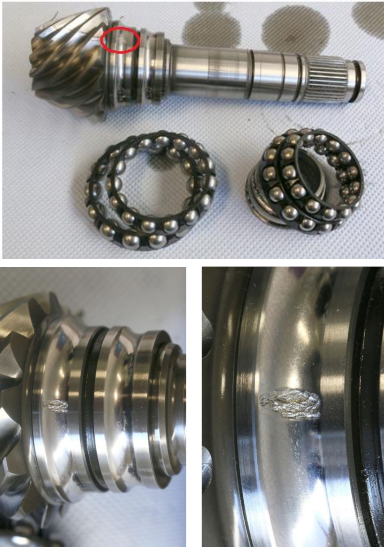
Abbildung 37: Pitting am Triblingskopflager Innenring
