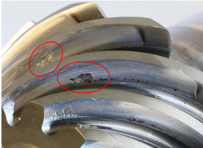
Abbildung 26: An zwei Stellen wurde bei der Kontrollzerlegung Pitting festgestellt, jeweils an der Zugflanke
