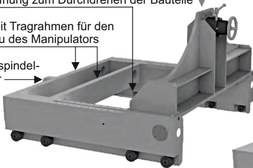
oder für längere Bauteile mit **Beiwagen** zum Aufbau des Reitstocks oder einer 2. Drehvorrichtung (leerlaufend oder mit synchronem Antrieb) lieferbar. Bei Ausrüstung des Manipulators mit einem Vertikalschlitten kann dabei auch der Reitstock oder die 2. Drehvorrichtung am Beiwagen auf einem gleichen, synchron bewegten Schlitten aufgebaut werden. Durch einstellbare „Mitnehmer“ kann der Beiwagenabstand verschiedenen Bauteillängen angepasst werden.
