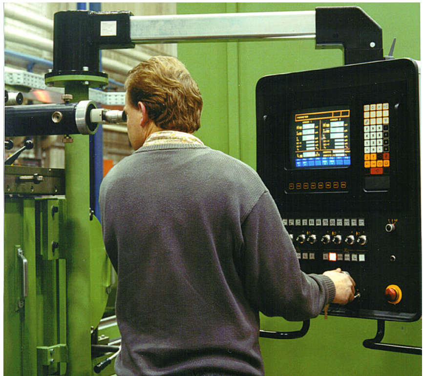
Bedienstand einer Trimetall-Sägebandanlage (47.10.12g/6)
