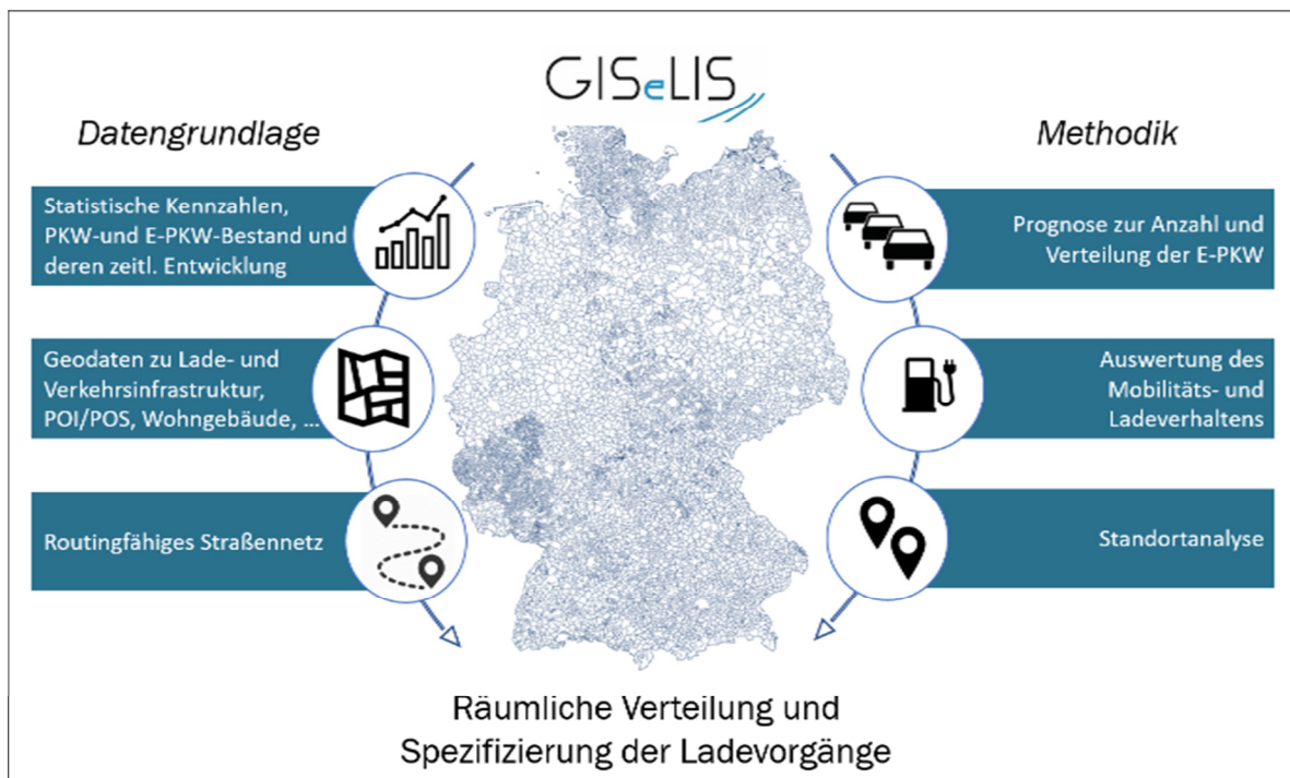
Abbildung 11: Funktionsweise des Standortmodelles für Ladeinfrastruktur GISeLIS
