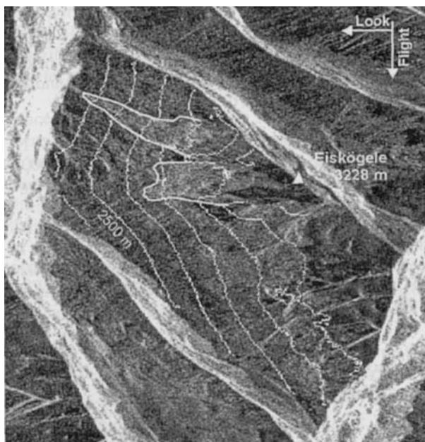
**Abb. 5:** Über mehrere ERS SAR-Bild Datensätze gemittelt Amplitudenbild der beiden Hochebenkar Blockgletscher (mit weißer Linie umrandet). Die 100 m-Höhenschichtlinien wurden durch INSAR bestimmt.
