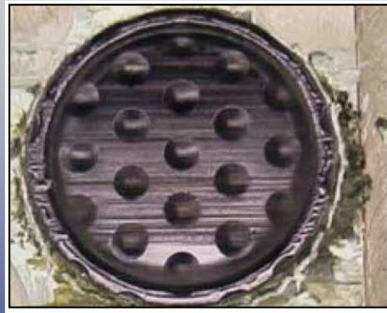
Versuchsstück nach 50km aufaddiertem Gleitweg
