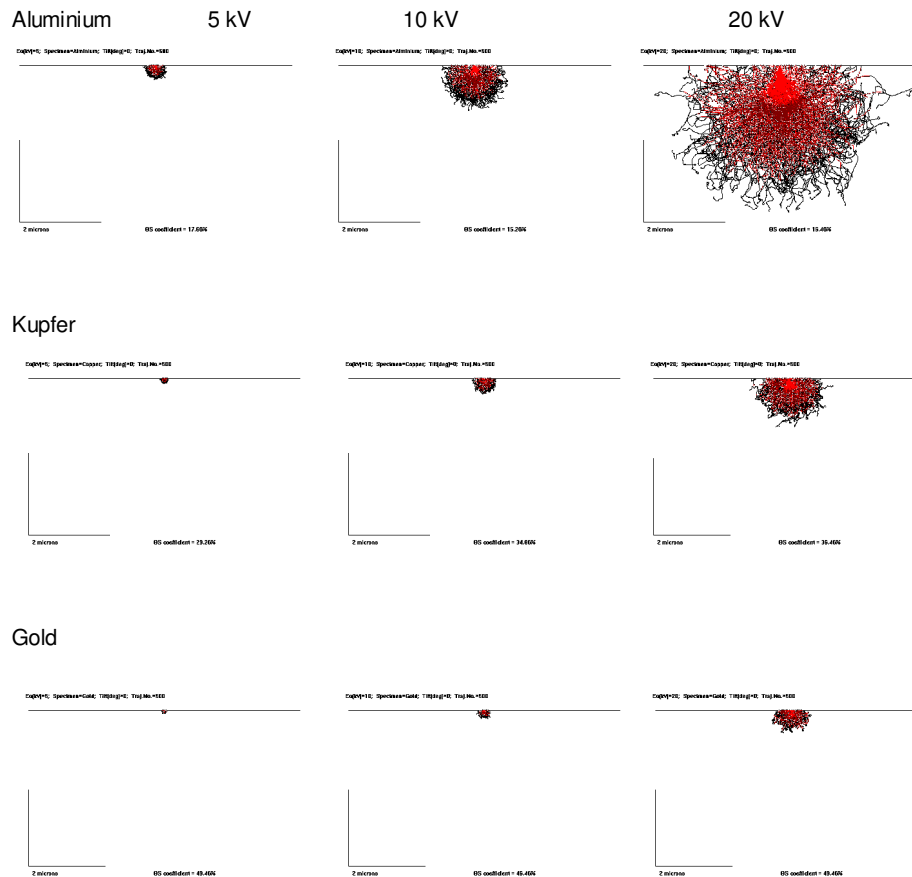
Abb. 16: Monte-Carlo-Simulationen der Elektronenstreuung bei verschiedenen Elektronenenergien und Probenmaterialien
