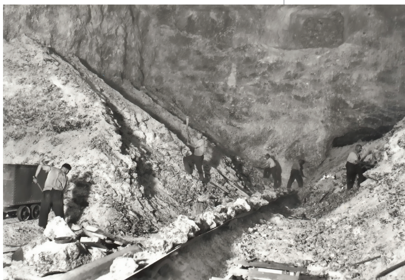
Abbildung 4: Steinsalzförderung 1929 mit Schüttelrutsche Quelle: Südwestdeutsche Salzwerke AG
