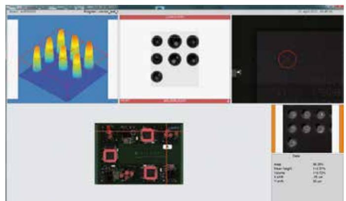
Am Verifikationsplatz stehen die Bilder und Daten aus allen Prüftoren zur sicheren Klassifizierung bereit
