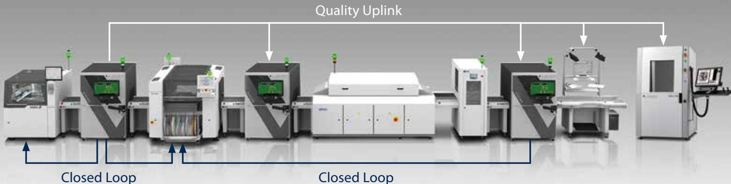
Linienvernetzung sowie bestmögliche Fehlererkennung und -vermeidung. Alle Prüfdaten, z. B. aus der 3D-Lotpasteninspektion, stehen auch auf dem MXI-Verifikationsplatz für eine ausführliche Analyse zur Verfügung. So lassen sie sich anwenderfreundlich mit den qualifizierten Daten und Bildern aus der Röntgenanalyse abgleichen.
