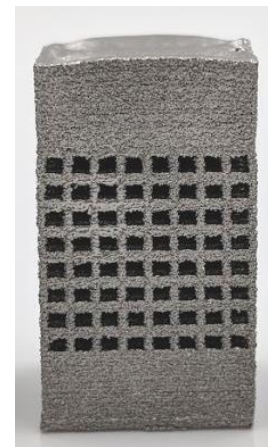
Abbildung 1: Additiv gefertigte Gitterstruktur für Druckversuche
