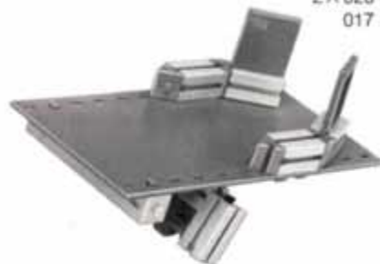
64.2 Leitblech mit Vibrator auf der Unterseite
