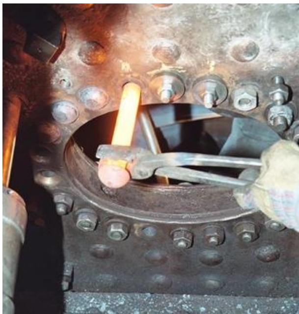
Beispiel Ersatz von einem Feuerlochring Eingeschraubter Ring Induktive Glühung der auf berechnete Länge gefertigten Niete Umformung nach dem Einsetzen mit dem Presshammer
