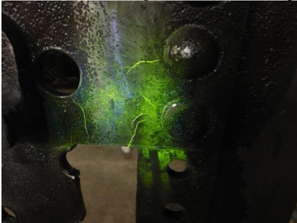
Deutliche Rissanzeigen nach MT-Prüfung
