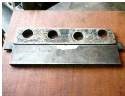
Blech-Blech-Stumpfnah P265GH neues Blech + altes Blech 400 x 200 mm
