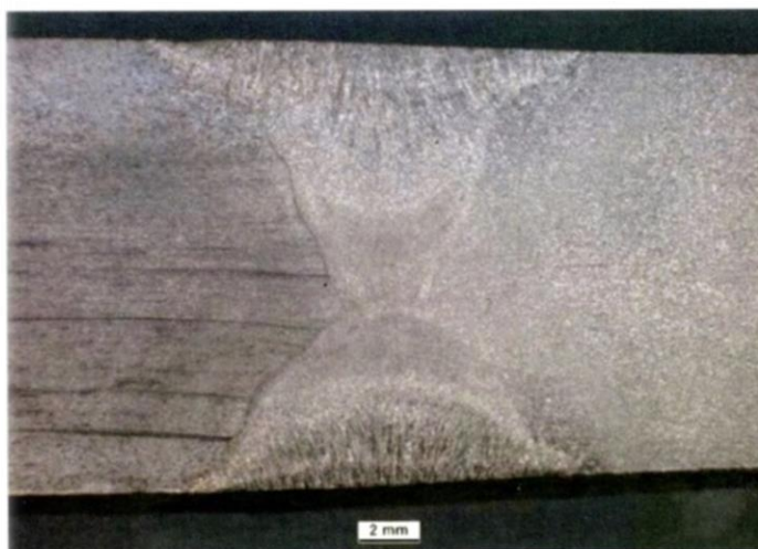
Abb. 1 Probe Nr. 1-8 Makrogefüge der Schweissverbindung links "altes" Blech - rechts "neues" Blech Befund: Fehlerfreier Nahtaufbau und einwandfreie Durchschweissung
