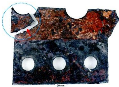
Bild 1: Übersichtsaufnahme des Blechmaterials aus der Dampflokotive, Wasserseite. Die Schadstelle (geöffneter Riss) ist eingezeichnet.
