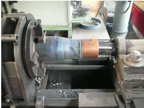
Eingezogenes und geglühtes Stahlrohr in der Lötvorrichtung mit dem Kupferstutzen und vorbereiteter Stumpfnah, Drehantrieb mit Frequenzsteuerung
