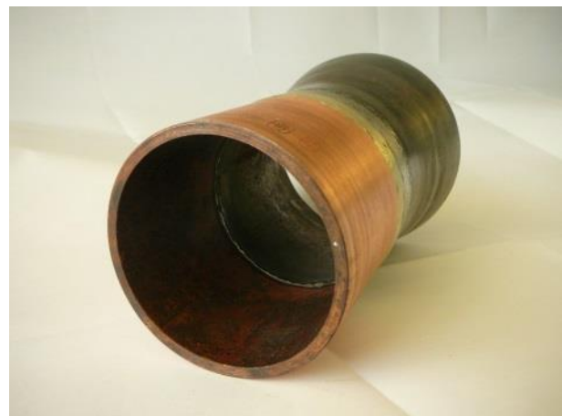
Prüfstück mit fertiger Hartlotverbindung Prüfungen: Sichtprüfung, VT, Durchstrahlungsprüfung RT, Farbeindringprüfung PT, Zugprobe bei 200°C und Biegeprüfung
