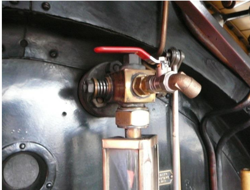
Stirnseitig eingeschraubtes Kugelventil am oberen Ventilkopf. Foto vor der Montage der Dampf-Ableitung in den gefahrlosen Bereich.
