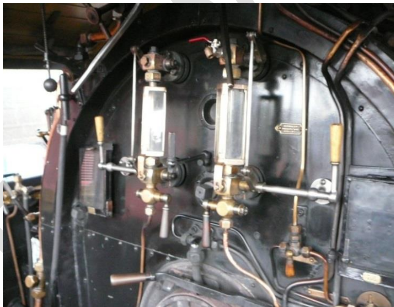
Stirnseitig eingeschraubtes Kugelventil am oberen Ventilkopf. Foto vor der Montage der Dampf-Ableitung in den gefahrlosen Bereich.
