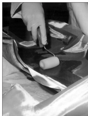
Herstellen eines Handlaminats mittels Schaumstoffwalze
