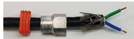
Figure / Abbildung 3.1.5.1: Stripping of single wires / Abisolieren der Einzelleiter
