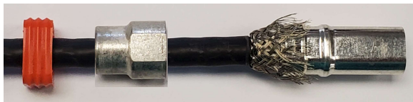
Figure / Abbildung 3.1.8.1: Braid slipping over / Überstreifen des Schirmgeflechts
