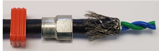
Figure / Abbildung 3.1.4.2 : Removal of the filler / Entfernen des Füllmaterials
