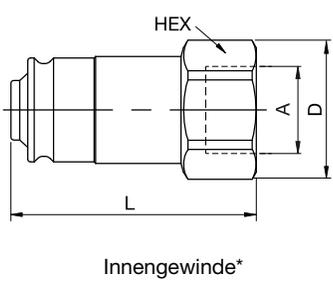
\*NPSF-Gewinde sind zylindrisch und für die optimale Montage mit langen, konischen NPTF-Außengewinden.
