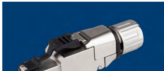
Der MFP8 von Telegärtner: werkzeuglos feldkonfektionierbar in weniger als 60 Sekunden und geeignet für Netze bis 40 Gigabit Ethernet
