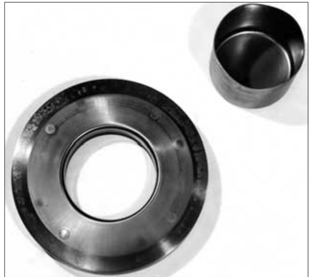
Bild 63: Nitrocarburierter Ziehring für die Herstellung von Näpfen
