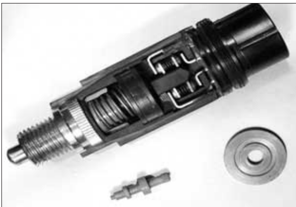
Bild 58: Nitrocarburierter Anker und Scheibe aus einem Steuerventil
