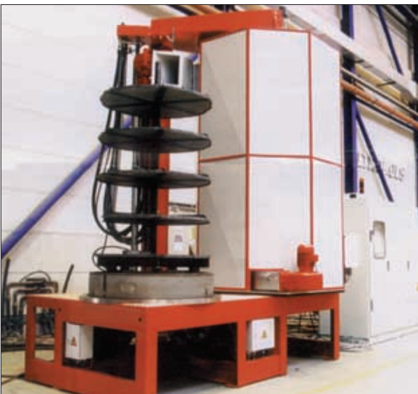
Bild 74: Plasmanitrier-/nitrocarburieranlage (Fa. Eltro GmbH)
