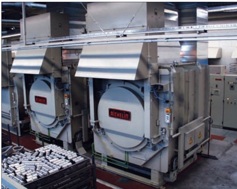
Bild 73: Kammer-Retortenofen zum Gasnitrieren/-Nitrocarburieren (Fa. Aichelin)
