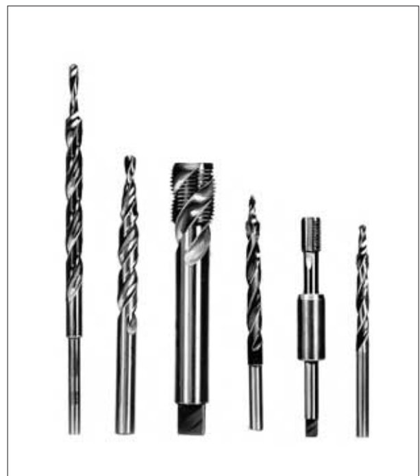
Bild 68: Nitrocarburierte Formschneidwerkzeuge zur Aluminiumbearbeitung
