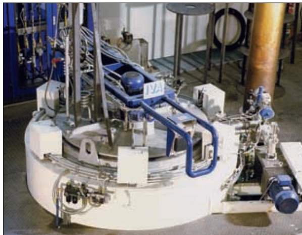
Bild 72: Retortenofen zum Gasnitrieren/ -nitrocarburieren (Fa. IVA)
