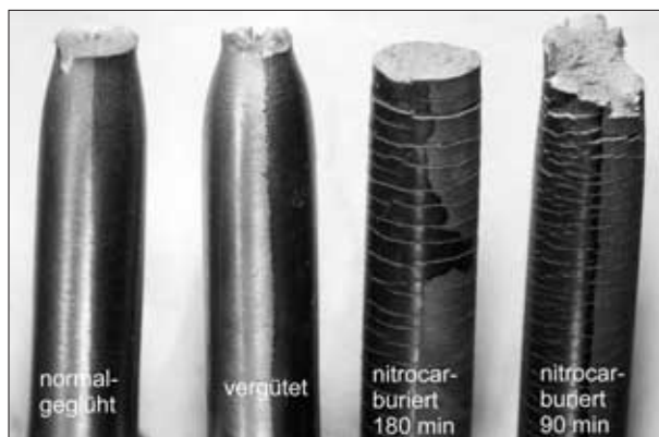
Bild 38: Zugproben aus dem Stahl 34Cr4 mit unterschiedlichem Gefügezustand
