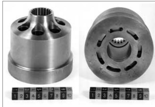
Bild 59: Nitrocarburierter Pumpenzylinder einer Axialkolben-Hydraulikpumpe
