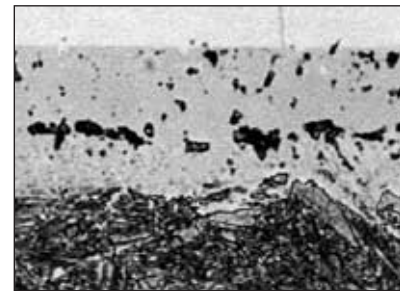
Bild 14 c: Grobe Streuporen, perl-schnurartig parallel zur Oberfläche angeordnet
