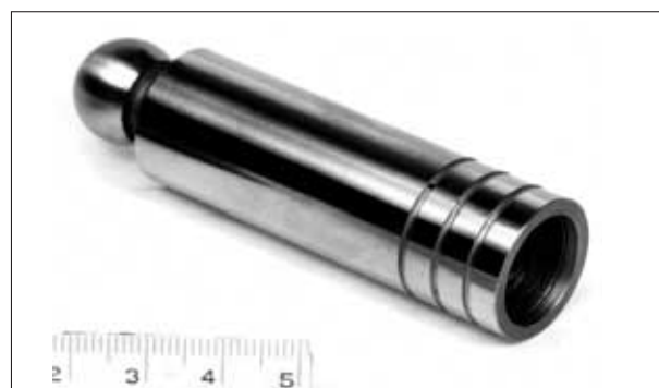
Bild 61: Nitrocarburierter Kolben einer Hydraulikpumpe
