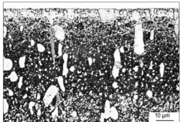
Bild 20: Randschicht des Stahls X165CrMoV12, salzbadnitrocarburiert, 570 °C, 2 h/Öl
