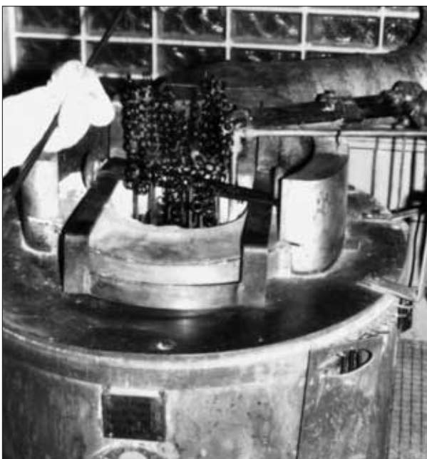
Bild 69: Salzbad-Tiegelofen zum Nitrocarburieren
