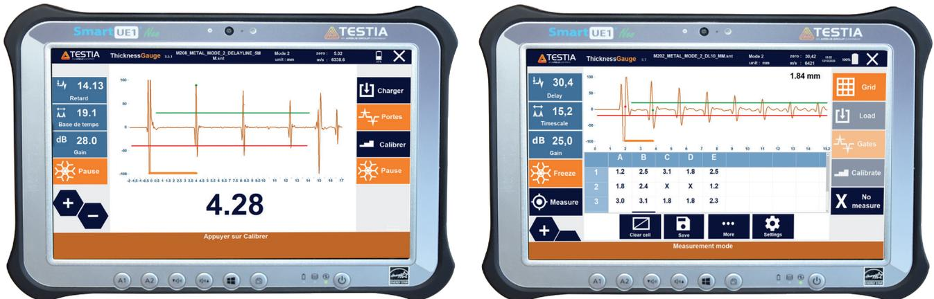
Das Smart UE1 ThicknessGauge, hier mit Direktanzeige der Messung sowie mit automatischem „Touch&Store“-Grid-Mapping
