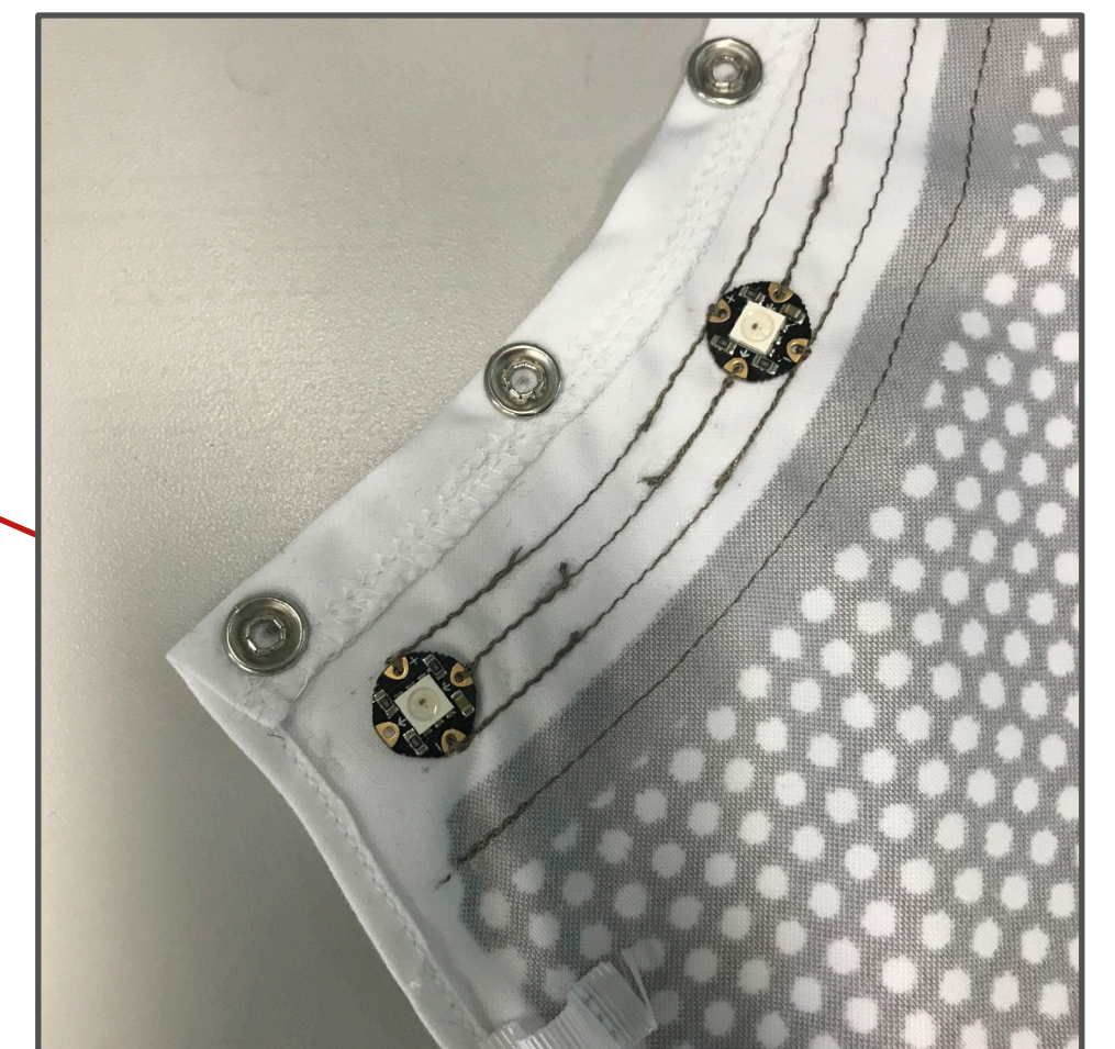
Abb. 5: LEDs, angestickt mit elektrisch leitfähigem Garn
