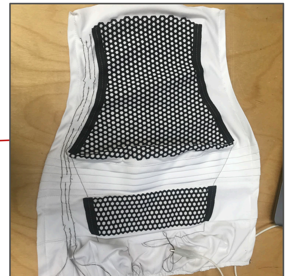
Abb. 4: Schnittmuster mit gedrucktem Wabenmuster und Ziehharmonikafaltung
