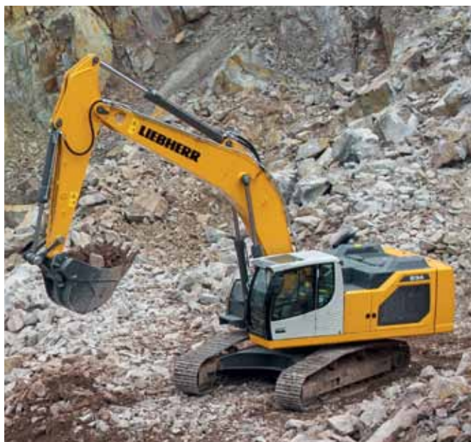
Die Generation 8 der neuen Raupenbagger punktet u. a. mit größeren Tieflöffeln, höheren Grabkräften und höherer Motorleistung.
