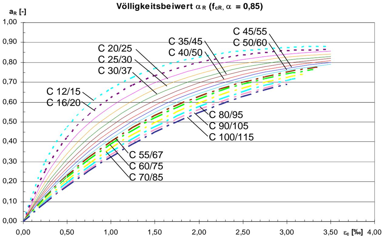
Bild 9: Hilfsdiagramm zur Ermittlung von  $\alpha_R$
