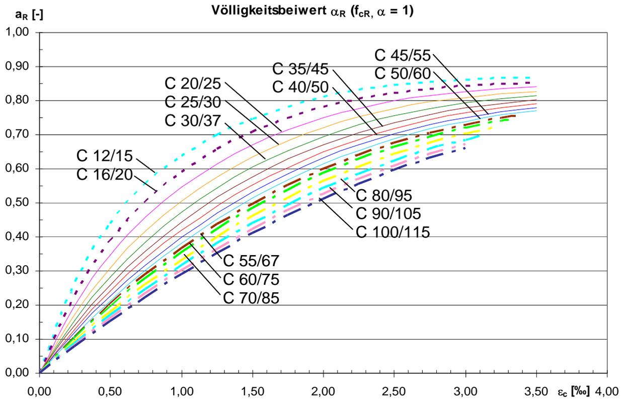
Bild 11: Hilfsdiagramm zur Ermittlung von  $\alpha_R$
