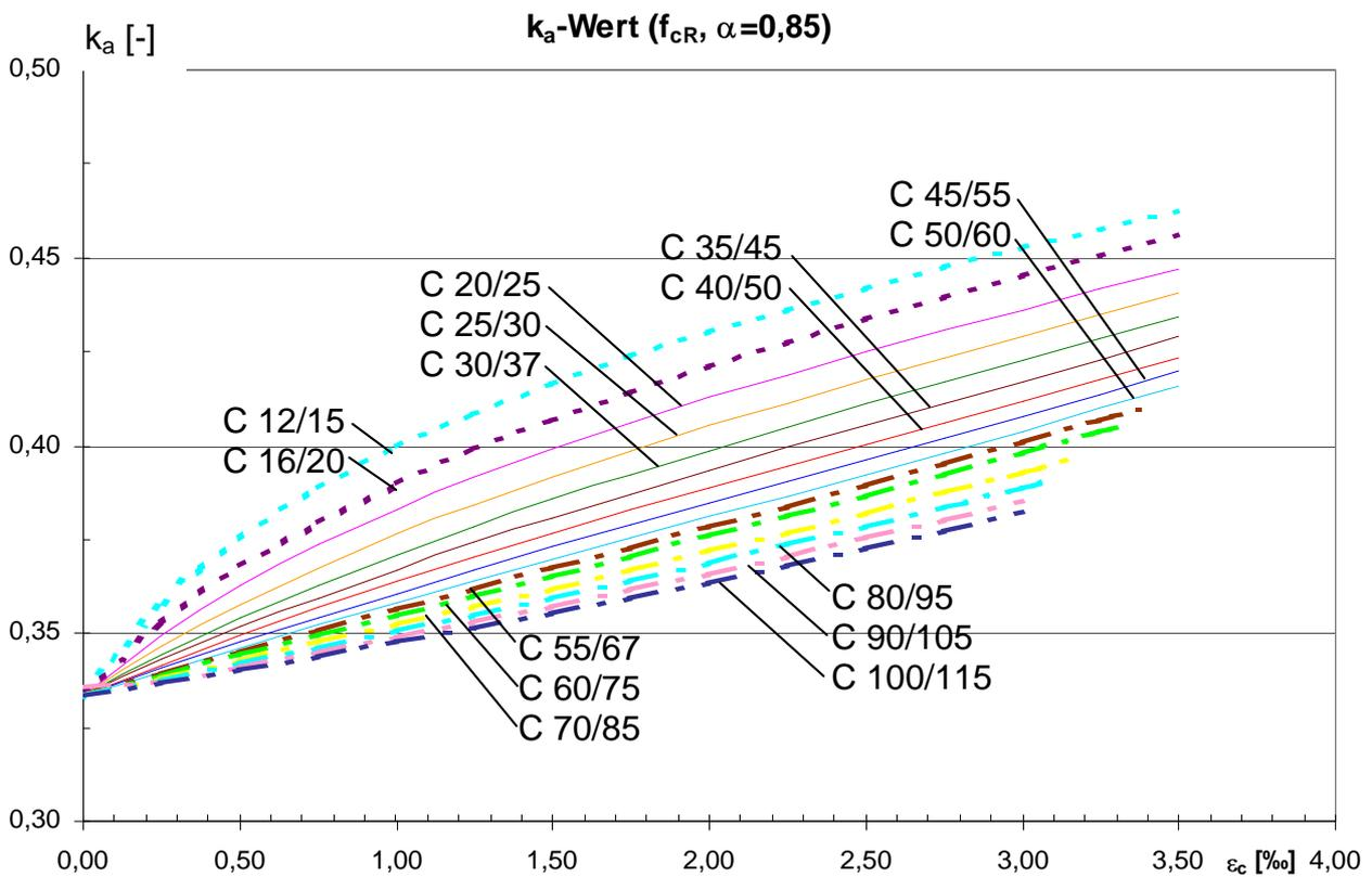
Bild 10: Hilfsdiagramm zur Ermittlung von  $k_a$
