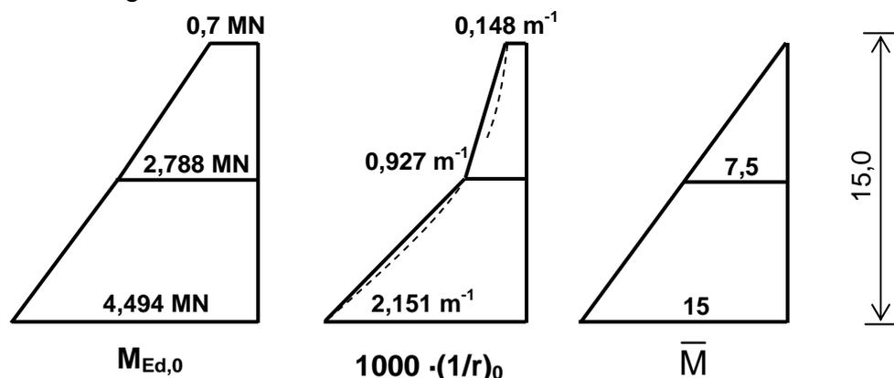
Bild 21: Momente und Krümmung infolge Belastung (Th. II. O.) und infolge Einheitslast
