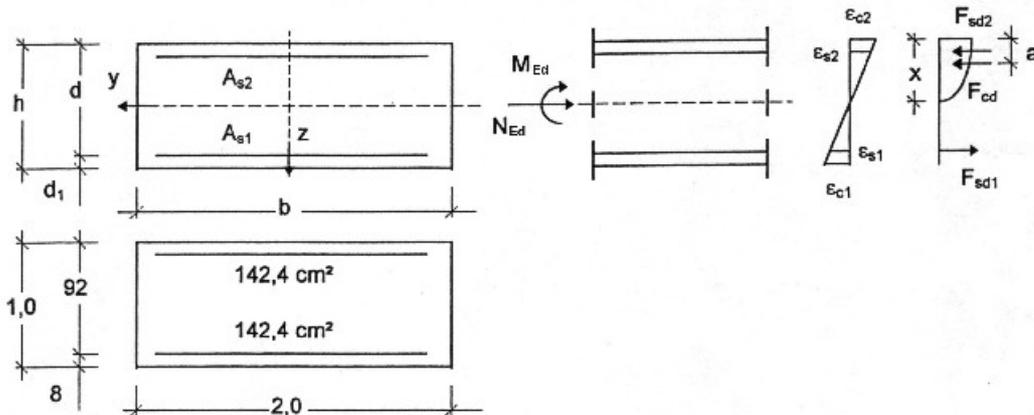
Bild 16: Querschnitt, Bewehrungsquerschnitt und Dehnungen
