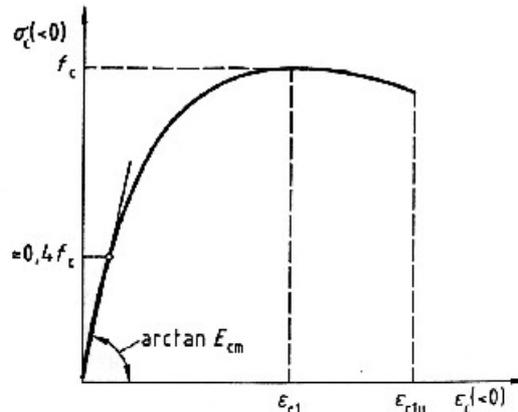
Bild 1: Spannungs-Dehnungs-Linie für die Schnittgrößenermittlung mit nichtlinearen Verfahren und für Verformungsberechnungen (Bild 22, DIN 1045-1)
