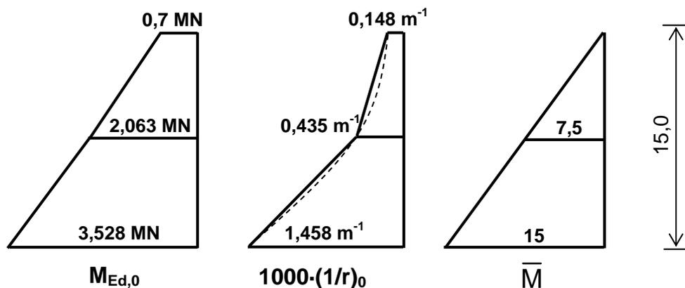
Bild 19: Momente und Krümmung infolge Belastung (Th. I. O.) und infolge Einheitslast
