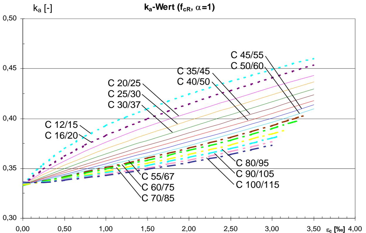
Bild 12: Hilfsdiagramm zur Ermittlung von  $k_a$
