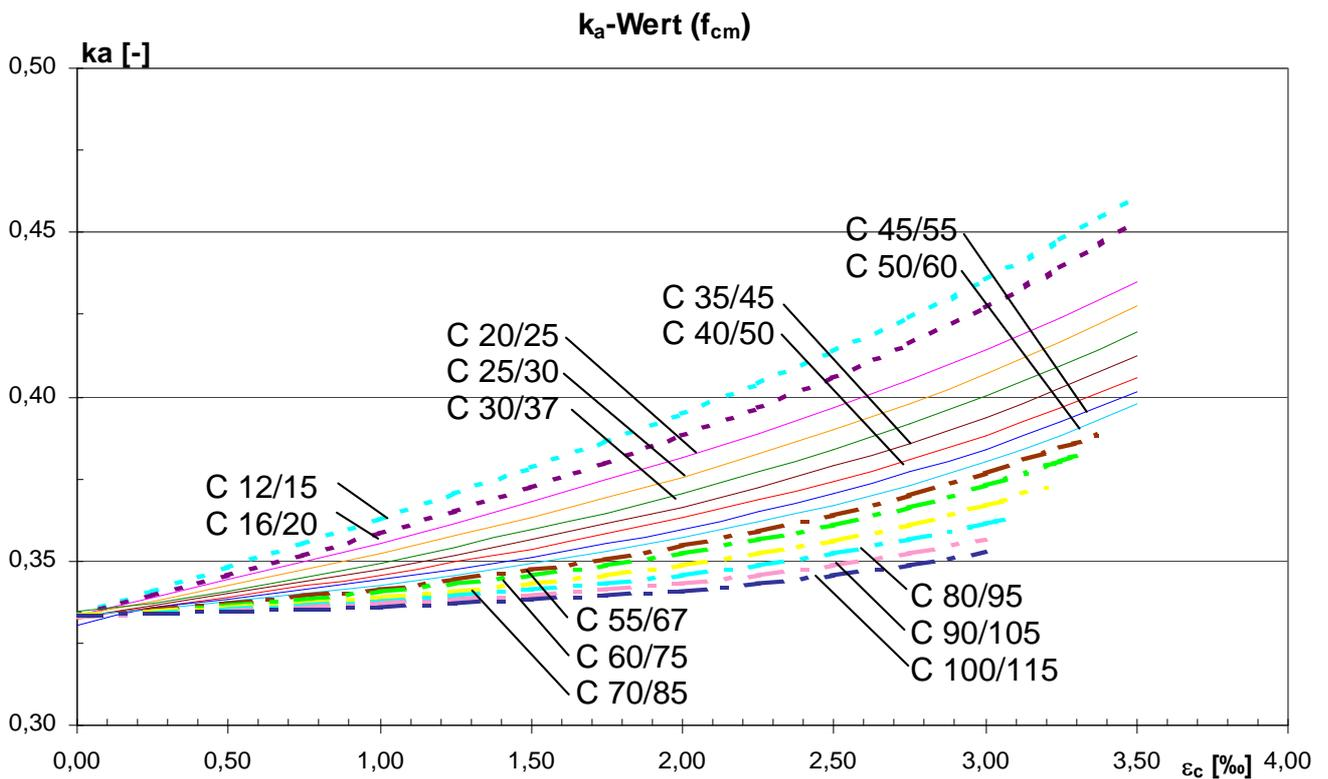
Bild 14: Hilfsdiagramm zur Ermittlung von  $k_a$
