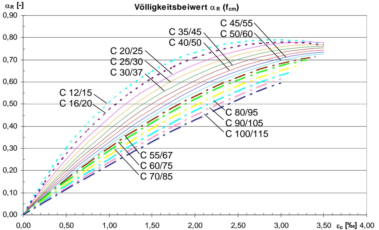
Bild 13: Hilfsdiagramm zur Ermittlung von  $\alpha_R$
