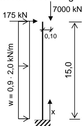
Bild 18: Statisches System und Belastung
