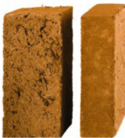
Abb. 5: Lehmsteine der Anwendungsklasse 1a als formgepresste Steine mit pflanzlichen Grobzuschlügen (Quelle 4, S. 296)
