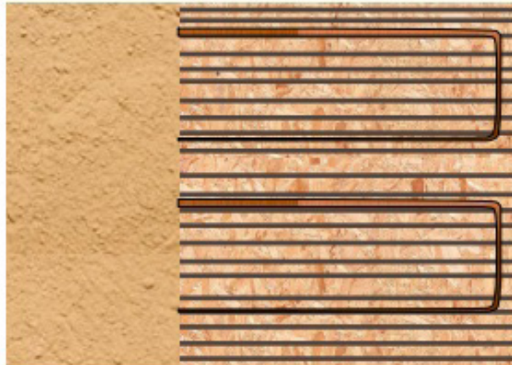
Abb. 7: Lehmplatte mit integriertem Wandheizsystem (eigene Darstellung)
