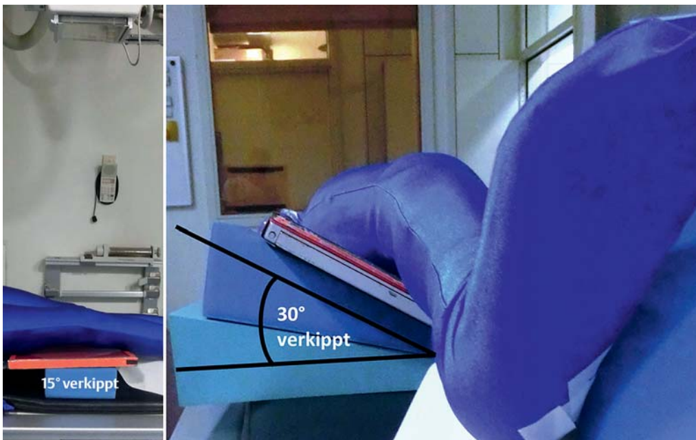
Abb. 17 Versuchsaufbau zur Darstellung eines Off-Level-Errors („verkipptes“ Raster). Die Keile unterhalb des Knies bewirken im linken Bild eine Neigung um 15°, im rechten um 30°.
