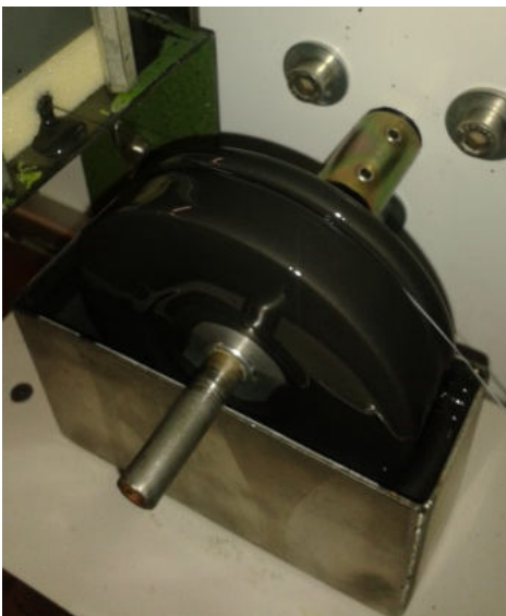
Abbildung 1: links - Aufbringen einer graphithaltigen Polymerbeschichtung auf Fadenmaterial mittels Pflatschverfahren; rechts - Polyester-Multifilament 110 dtex f36) mit Graphitbeschichtung
