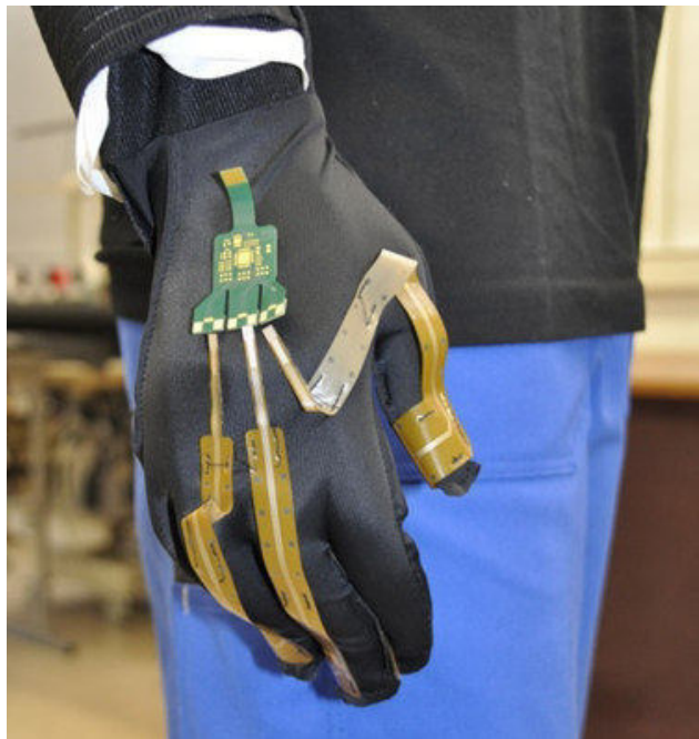
Abbildung 2: Sensorintegration von Foliesensoren (Würth Elektronik) am Handschuh
