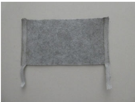
Abbildung 3: Mittels Klebevlieses kontaktierte Spannungszuführungselektroden einer Heizfläche
