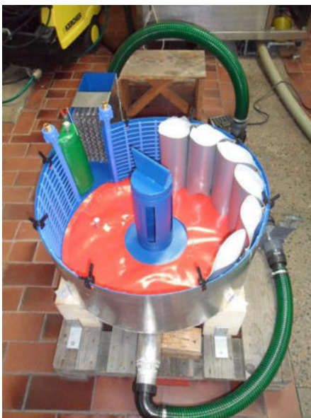
Abbildung 1: Modell des Wirbelbeckens mit Textilien zur Strömungsbeeinflussung
