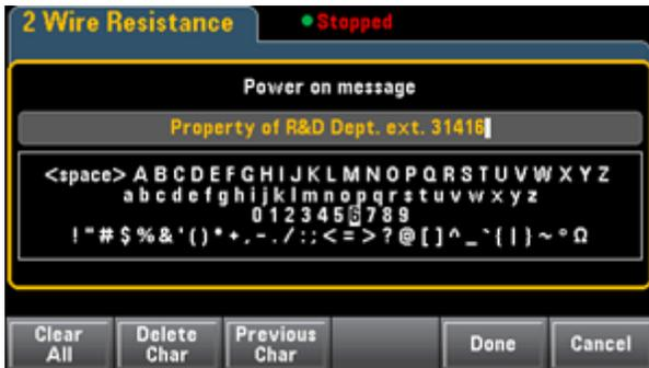
Verwenden Sie die Pfeiltasten am vorderen Bedienfeld und die Taste **[Select]** zur Auswahl der Buchstaben. Drücken Sie dann auf **Done**, um das Feld zu verlassen und die Meldung zu speichern. Die Meldung wird wie unten dargestellt angezeigt, wenn Sie das Gerät einschalten oder auf **[Help] > About** drücken.
