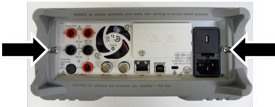
5. Entfernen Sie die Schraube unten am Gerät und bewahren Sie sie bis zur Montage an einem sicheren Ort auf. Schieben Sie die Abdeckung vom Gerät.
