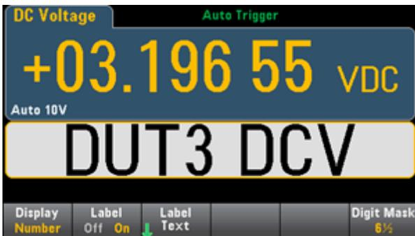
Drücken Sie zur Eingabe des Texts **Label Text** und verwenden Sie die Softkeys und die Frontplattentasten zur Änderung der Bezeichnung (s. unten). Drücken Sie dann **Done**. Beachten Sie bitte, dass der Schriftgrad der Bezeichnung automatisch kleiner wird, um auch längere Bezeichnungen zu ermöglichen.
