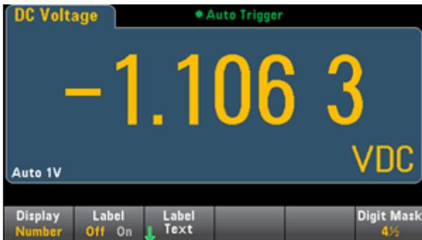
Der Softkey **Auto** zeigt an, dass die Anzahl angezeigter Ziffern auf anderen funktionspezifischen Einstellungen basieren wie die Messungsapertur, die in NPLCs eingestellt wird. Messungen werden stets gerundet, aber nie abgekürzt.
