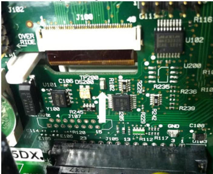
10. Prüfen Sie weiterhin, dass die Spannung am Widerstand R121, der auf das Geräte-Chassis bezogen ist,  $3,3\text{ V} \pm 5\%$  beträgt. Ist die Spannung nicht korrekt, muss die Platine der Frontplatte ausgetauscht werden.
