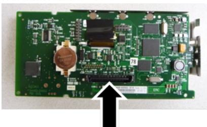
11. Entfernen Sie die ESD-Abschirmung, indem Sie sie vorsichtig aus dem Kunststoffgehäuse herausdrücken, mit dem sie verbunden ist.
