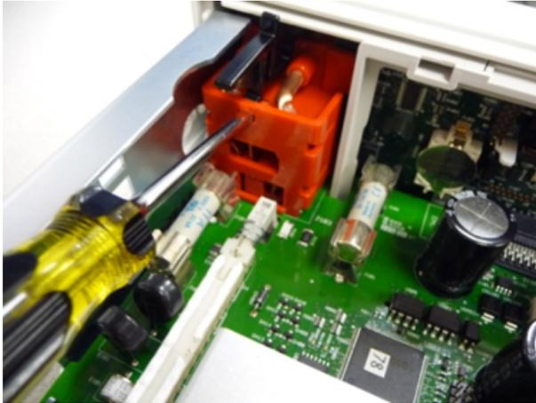
7. Drücken Sie den Hebel nach unten und drücken Sie den Metallrahmen des Geräts, um das Kunststoffelement an der Frontplatte freizugeben.
