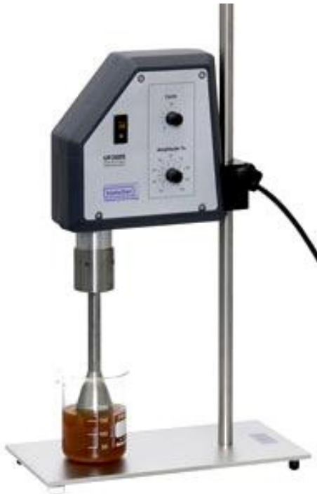
Gerät zur Unterstützung der Feinstkornprüfsiebung: Ultraschall Desintegrator UDS 751/UP 200S
