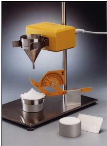
Böschungswinkelbestimmung mit dem EMS 755
