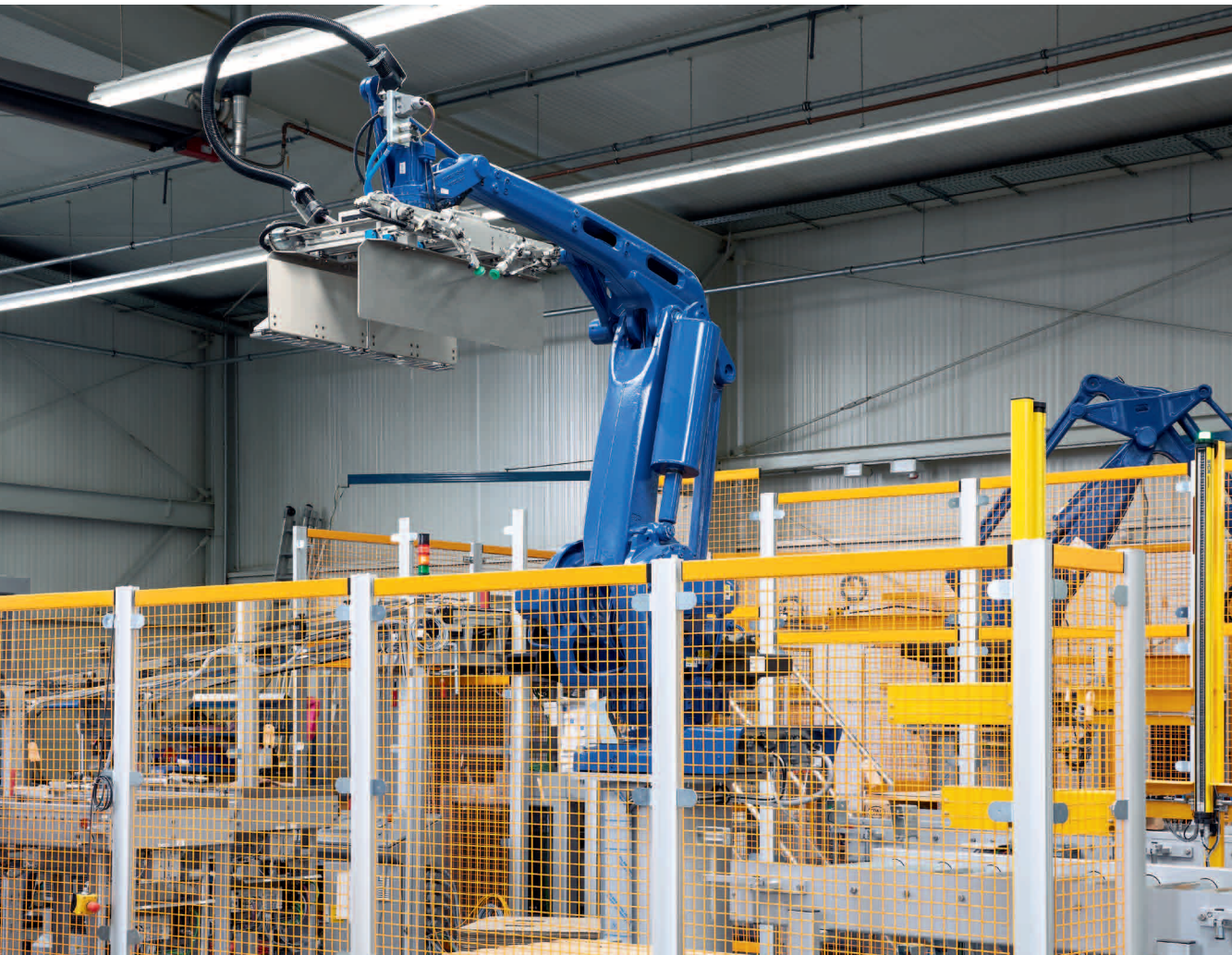
Optimale Raumnutzung: Das Palettiersystem bildet das Ende einer hochautomatisierten Verpackungslinie.
