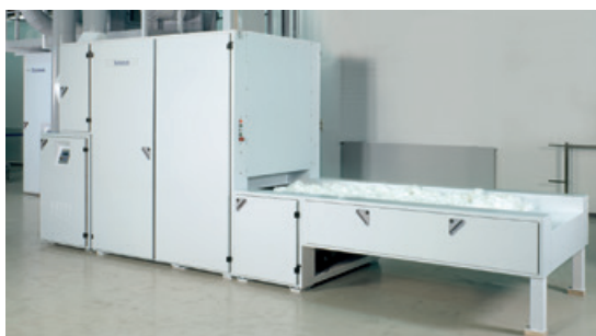
Der Kompakt-Ballenöffner BO-C ist ideal zur Speisung einer kleinen Chemiefaseranlage und kann direkt einen Öffner speisen.
