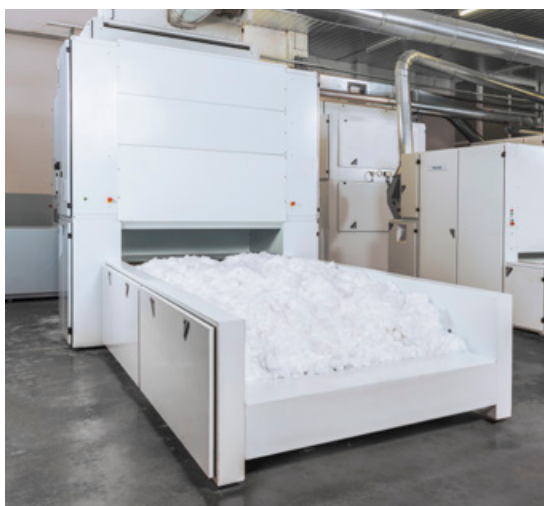
Universal-Ballenöffner BO-U (hier in der Version mit einem Einspeiseschacht)
