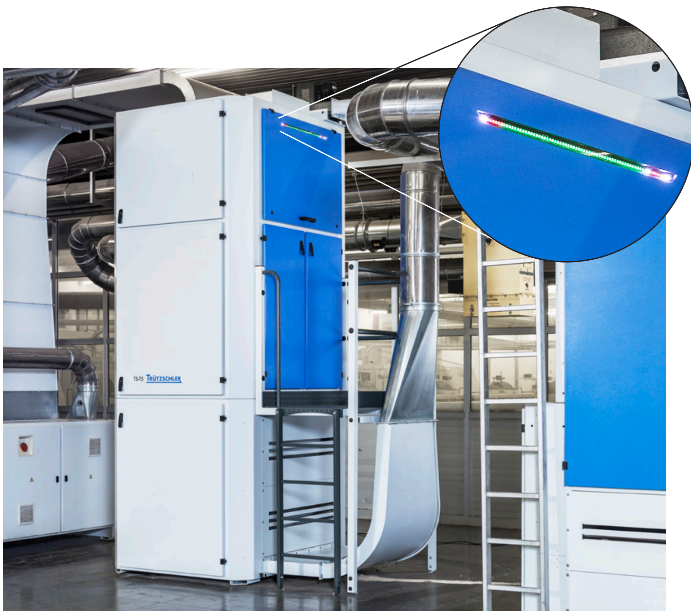
Die Trützschler Fernanzeige T-LED visualisiert von weitem sichtbar die Maschinenzustände.
