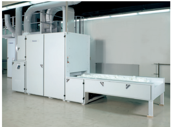
Kompakt-Ballenöffner BO-C mit Feinöffner TO-C für Produktionen <300 kg/h
