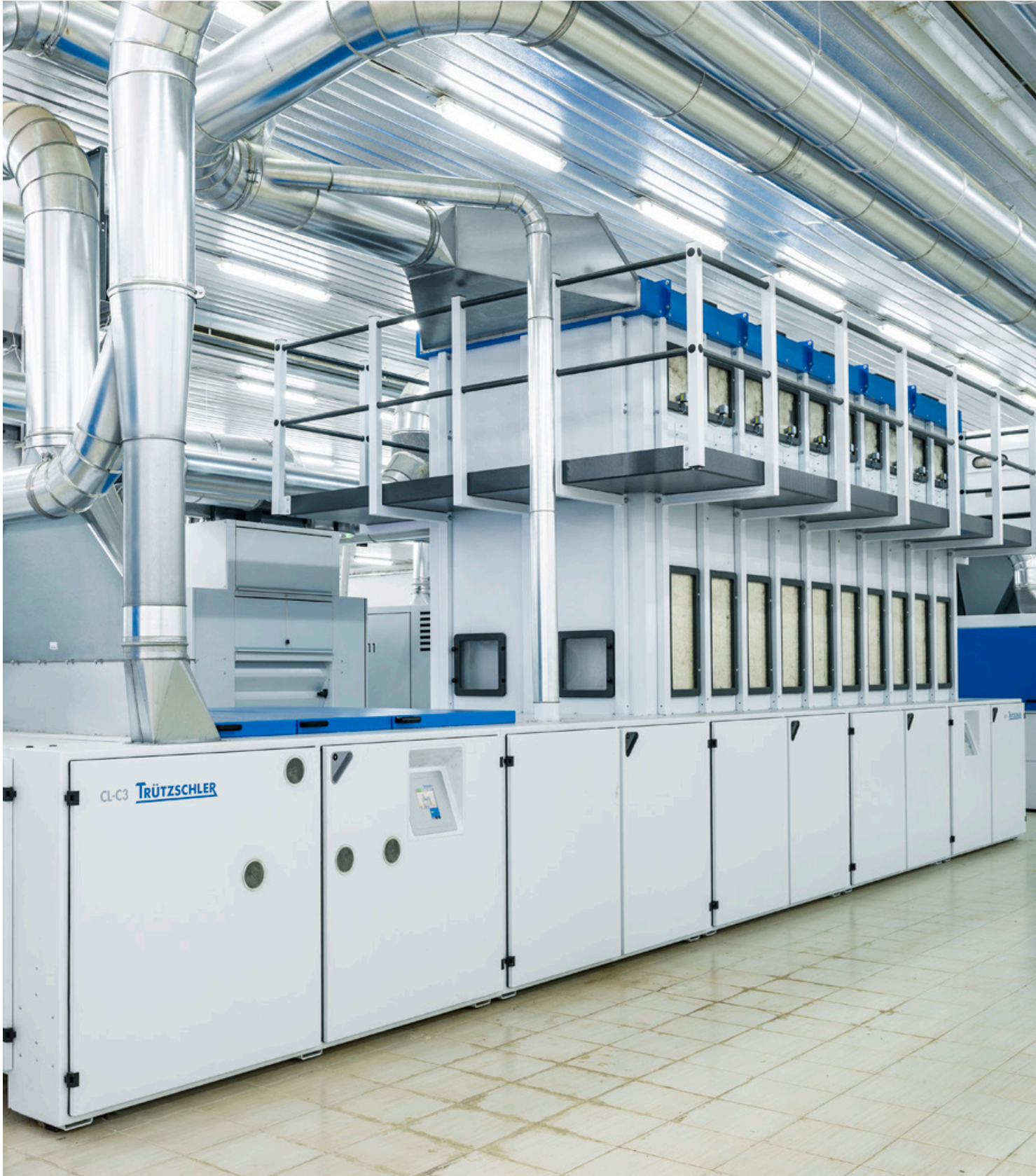
Integrierter Mischer MX-I10 – direkt mit einem Reiniger CL-C3 gekoppelt
