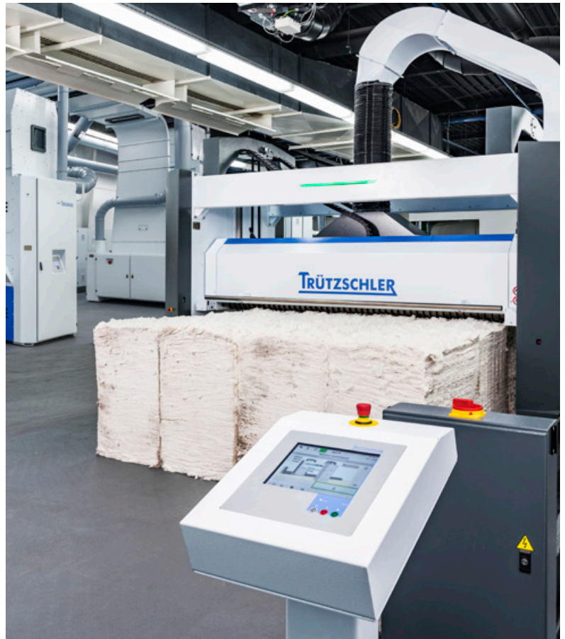
Das Bedienterminal des Portal-Ballenöffners BO-P visualisiert die wichtigsten Daten.
