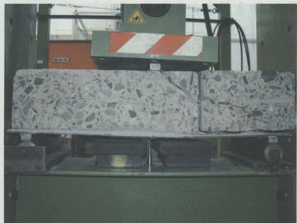
Bild 22: vorgeschädigter Balken nach Versuch
