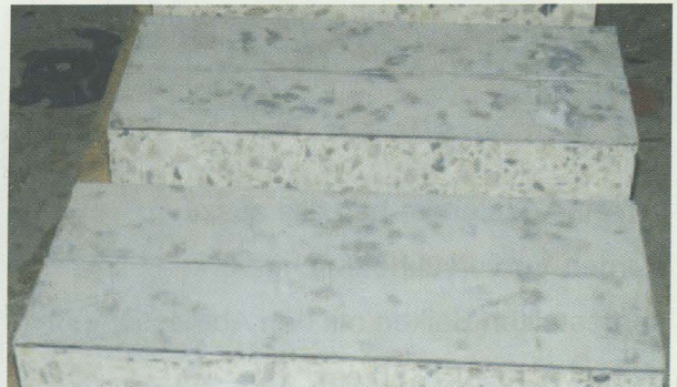
Bild 17: Versuchskörper mit Stahllamellen
