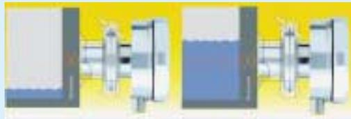
hall bedeutet einen leeren, ein kürzerer einen vollen Behälter. Dieses Verfahren wertet nur das Reflexionsverhalten der dem Sensor benachbarten Behälterinnenwand aus. Was sich im Behälter abspielt, ist nicht von Interesse. Es besteht kein Einfluss von Verunreinigungen oder Luftblasen im Medium oder durch Einbauten und Rührwerken. Problematisch sind Medienreste an der Innenwand im Leerzustand.
