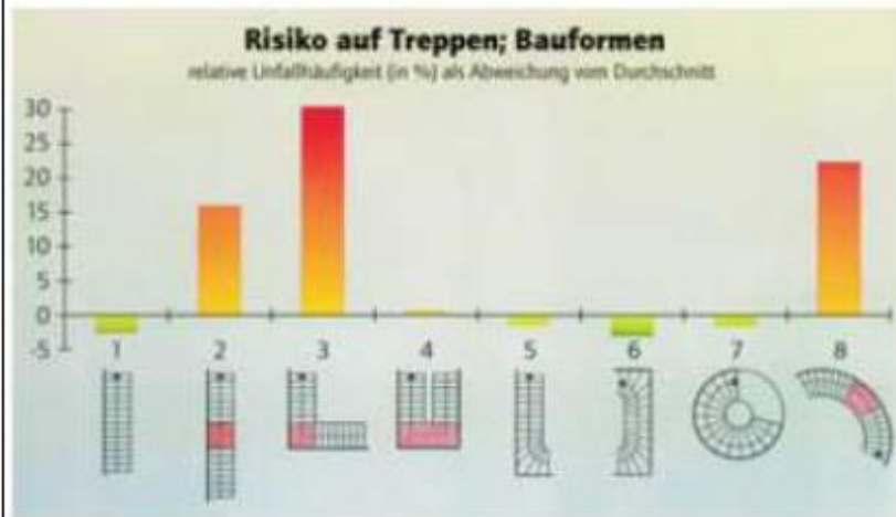
Bild 2: Unfallhäufigkeit auf Treppen mit und ohne Zwischenpodest
