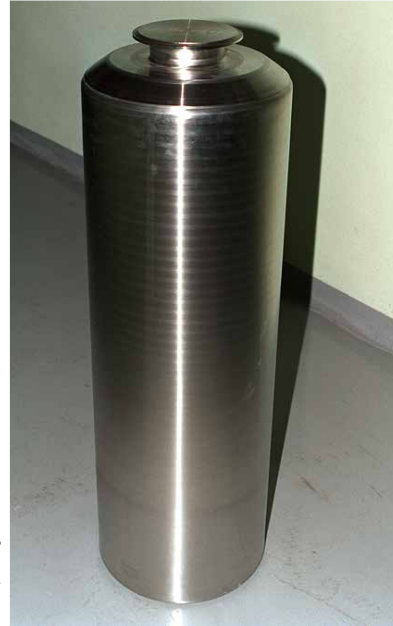
Quelle | Bild: Verglaste Abfälle in Glaskokille © GNS
