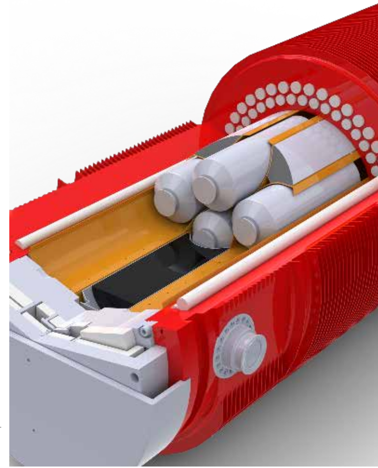
Quelle | Bild: Castorbehälter im Schnitt © GNS
