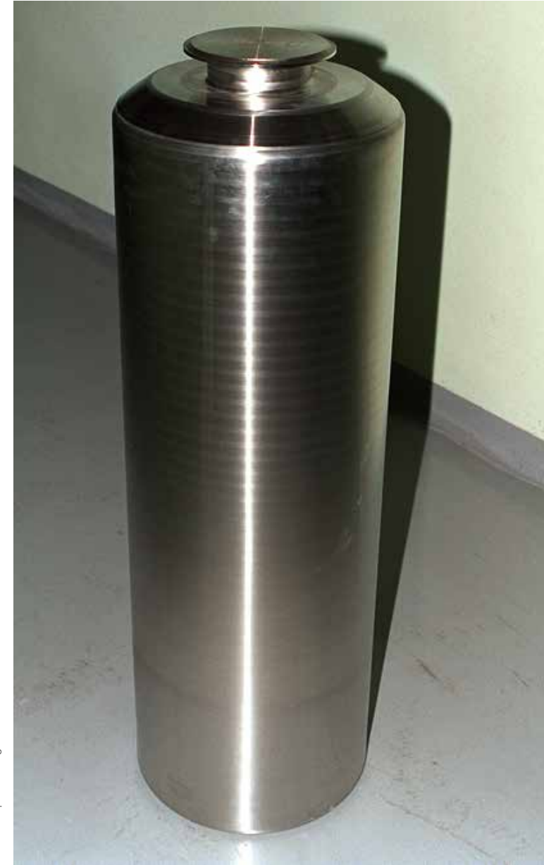
Quelle | Bild: Verglaste Abfälle in Glaskokille © GNS
