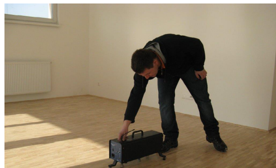
Messaufbau bei einer bauakustischen Überprüfung
