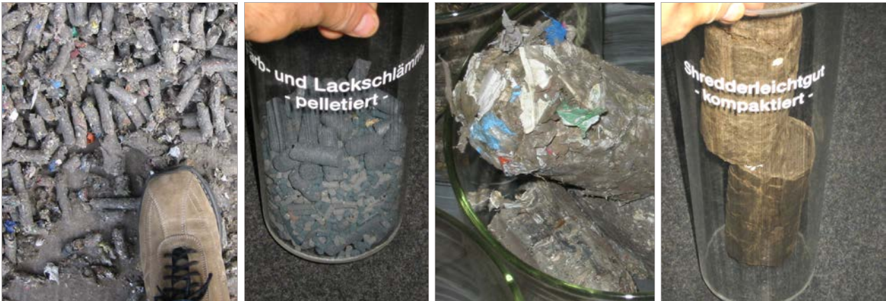
Abbildung 3.49: In der Festbettvergaseranlage im SVZ eingesetzte Restmüll- (links) und Lackschlammpellets (2. Bild von links; hergestellt nach dem Herhof-Trockenstabilat-Verfahren), DSD-Kunststoffbriketts (2. Bild von rechts) und Briketts aus Shredderleichtgut (rechts; eigene Aufnahmen 2003).
