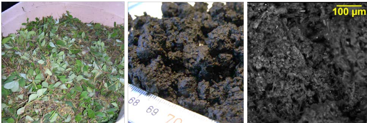
Abbildung 2.7: Hydrothermale Karbonisierung. Links: Edukt; Mitte: Produkt; rechts: (anderes) Produkt vergrößert [Ramke 2011, Wallmann 2011].
