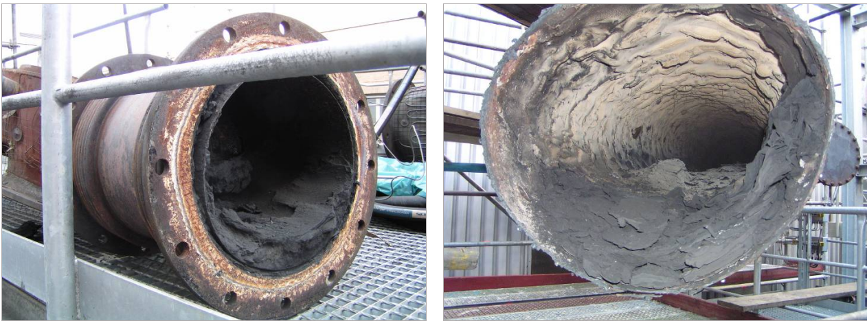
Abbildung 3.31: ConTherm-Verfahren - Durch Ablagerungen verblockte Pyrolysegasleitungen [Spindeldreher 2004].
