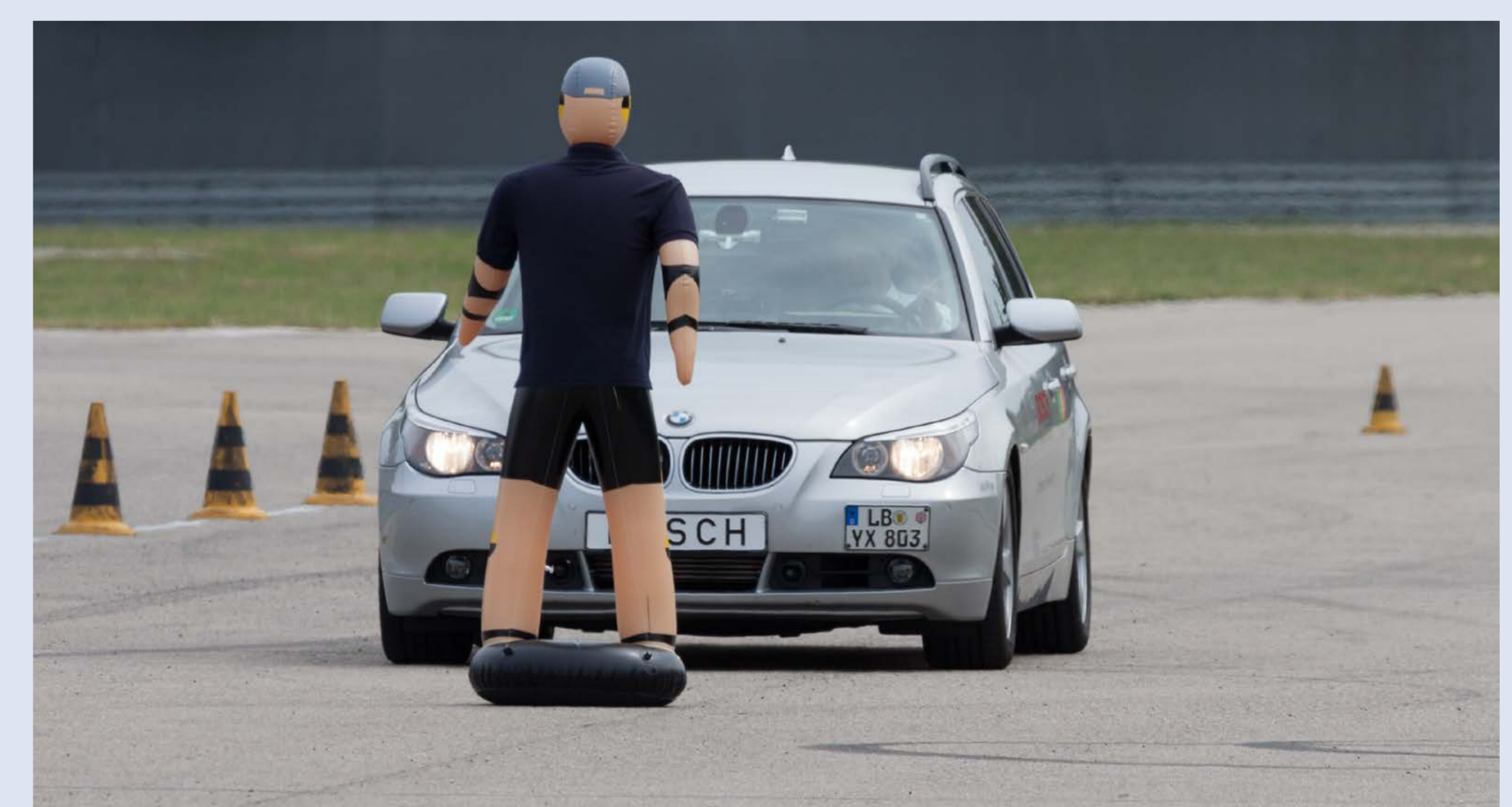
Versuchsträger beim Test mit Fußgänger-Dummy
