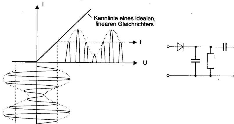
Abbildung 3: Demodulation durch Hüllkurvengleichrichtung
