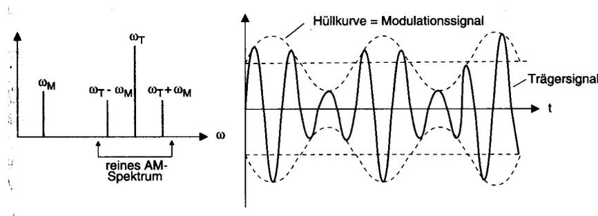
Abbildung 2: Spektrum und Zeitfunktion der Amplitudenmodulation
