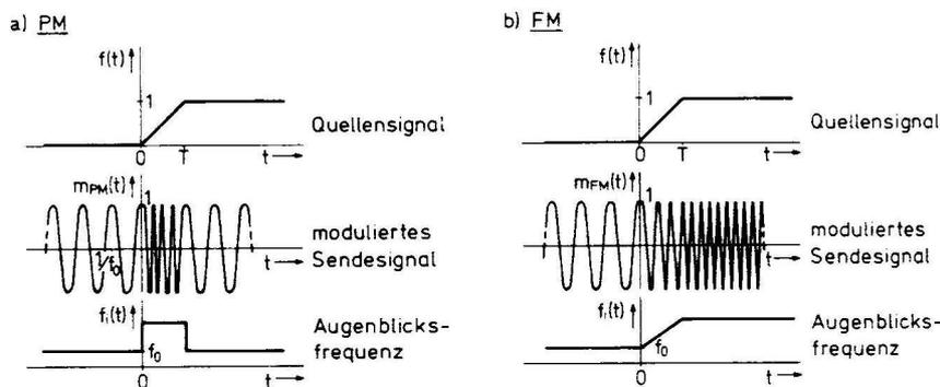
Abbildung 4: Beispiel zu a) Phasen- und b) Frequenzmodulation
