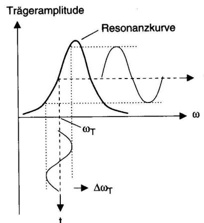
Abbildung 5: Einfacher FM-Demodulator
