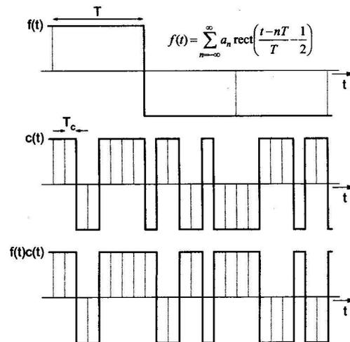
Abbildung 8: Nutzsinal  $f(t)$ , Codefolge  $c(t)$  sowie moduliertes Signal bei DS–CDMA
