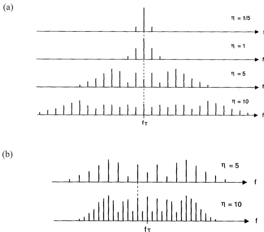
Abbildung 7: (a) Betrag von FM-Spektren mit konstanter Modulationsfrequenz und wachsender Modulationsamplitude (b) Betrag von FM-Spektren mit konstanter Modulationsamplitude und fallender Modulationsfrequenz. (In (a) und (b) sind nur die positiven Frequenzen berücksichtigt.)
