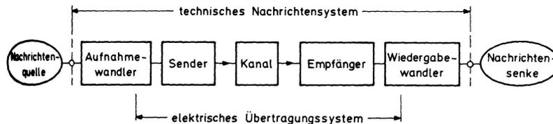
Abbildung 1: Schema eines Übertragungssystems
