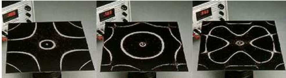
Abbildung 9: Chladnische Klangfigur mit quadratischer Platte (Uni Kalifornien, San Diego)
