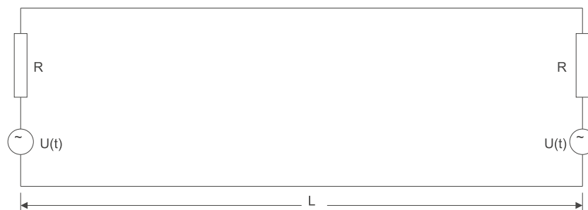
Abb. 2.74.: Nyquists Anordnung zur Berechnung der Rauschspannung an einem Widerstand
