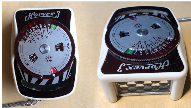
Abb. 4.145.: Belichtungsmesser von 1950 mit einer Selen-Photozelle
