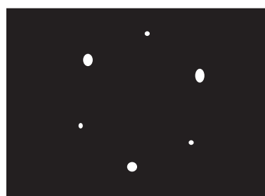
Abb. 4.297.: Schematische Skizze eines LEED-Bildes von Ni(111) bei einer Primärenergie von 205 eV (gezeichnet nach [JSJY82]).
