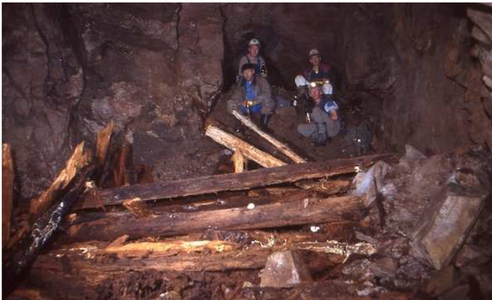
Bild 13: Schuttkegel des verfüllten Stollntraktes in Richtung Mundloch. Die Befahrer sitzen direkt vor dem mit Hölzern abgedeckten Erkundungsgesenk.
