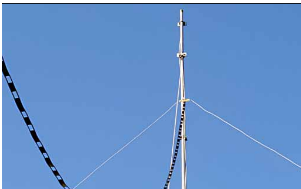
Aufhängepunkt mit 450-Ω-Hühnerleiter
