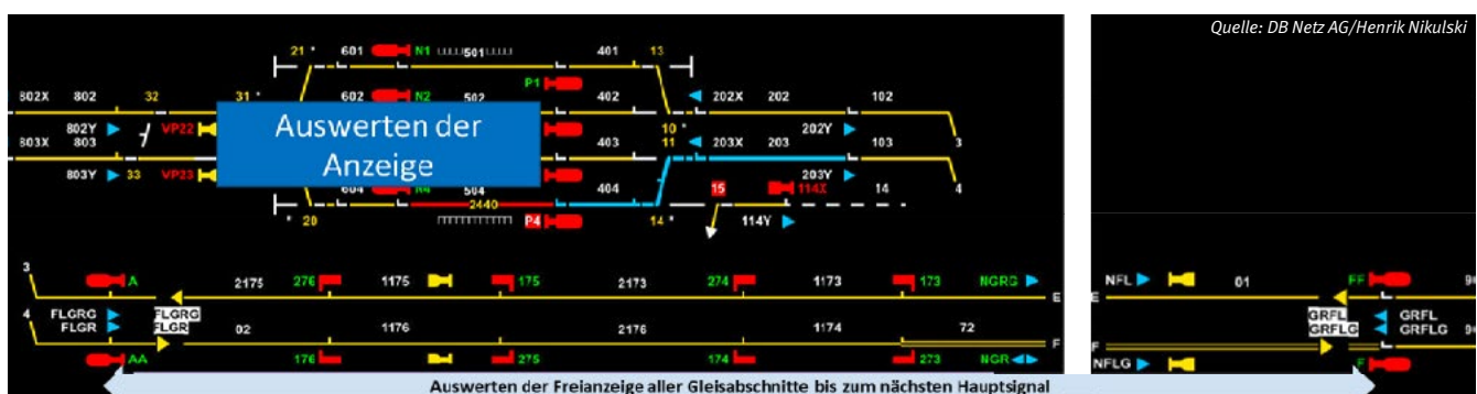
Abbildung 5: Auswerten des Freiseins aller Gleisabschnitte bis zum nächsten Hauptsignal als ein Element des Ersetzens einer Einzelräumungsprüfung (Beispiel mit 2 Lupen)
