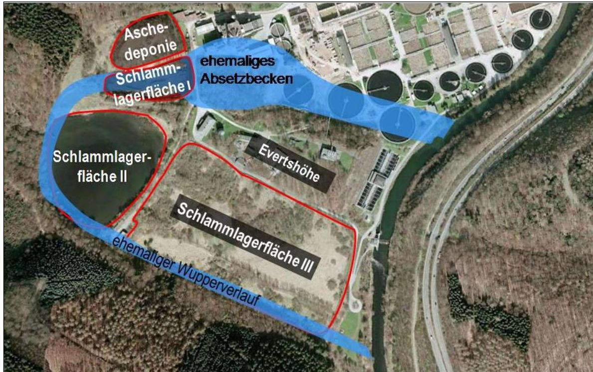
**Abbildung 3:** Lage der alten Wupperschlinge und der Klärschlamm-lagerflächen auf dem Betriebsgelände [18]
