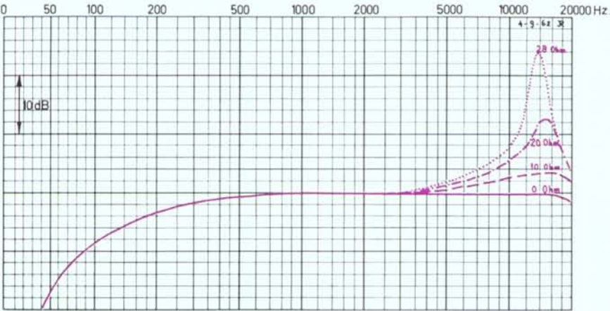
Abb. 8 Elektrische Frequenzkurven eines 3-Transistoren H. D. O. Geräts, mit Schaltung nach Abb. 5, aber ohne Kondensator C_2 . R_{\text{Batterie}} als Parameter. Bem.: Bei 28 Ohm Batteriewiderstand wird das Gerät instabil.
