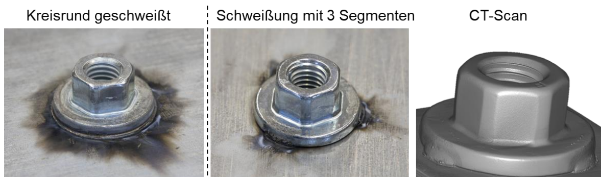
Abbildung 7: Typische Schweißnähte der Mutterverbindungen, links: kreisrund, rechts: drei Segmente.
